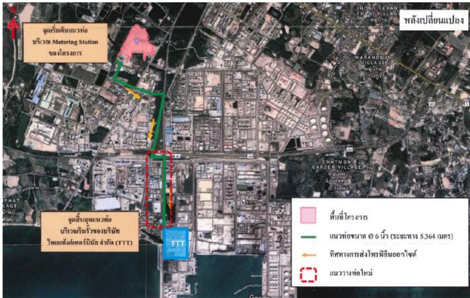
ภาพที่ 2.13 แนวท่อน้ำส่งผลิตภัณฑ์โพรพิลีนออกไซด์จากพื้นที่โครงการไปยังบริษัท ไทยแทงค์ เทอร์มินัล จำกัด
